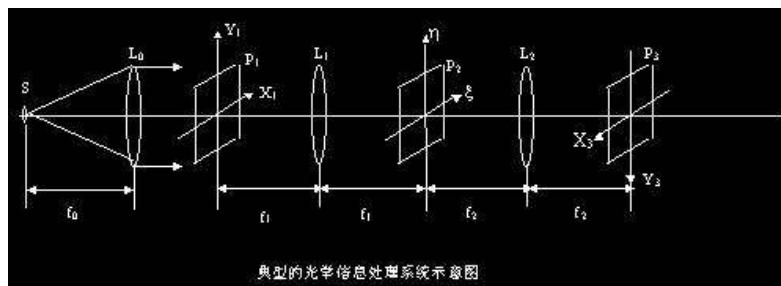
上图为典型的光学信息处理系统示意图, S为对激光进行扩束的短焦距透镜, L0为使扩束后的激光束变为平行光的准直透镜。(x<sub>1</sub>, y<sub>1</sub>)为物平面, L1为第一个傅里叶变换透镜, 它从物面发出的衍射光并在后焦面(x, h)上形成物体的频谱。(x, h)上可以放上各种空间滤波器以完成光学信息处理的任务。L2为第二个傅里叶变换透镜, 它的作用是对经处理后的物的频谱在进行一次傅里叶变换(相当于一次逆傅里叶变换只是坐标反转了)。这样就可以得到经特殊处理的图像。
