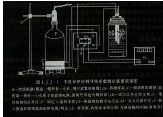
图 1.2.2-1 不良导热材料导热系数测定装置原理图
