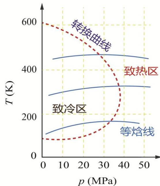
曲线内测  $\alpha_i > 0$  节流降压，气体降温（致冷区）；
