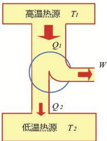
准静态循环, 工质为理想气体, 只和两个恒温热库交换热量, 由两条等温线和两条绝热线组成。
