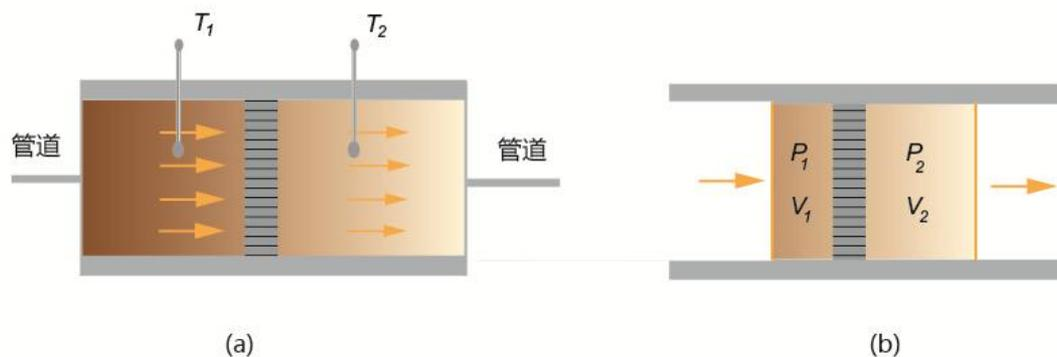
气体在高压泵作用下被压过多孔塞，维持气体在多孔塞两边的压强恒定不变，而且保持一定的压强差，此过程称为节流过程。因为这节流过程是在对外绝热的管内进行的，所以这节流过程也是绝热的。
