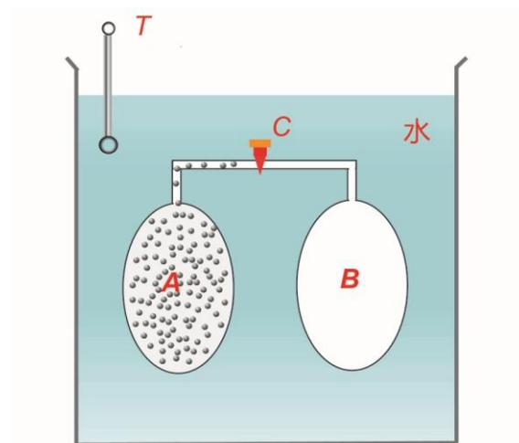
气体在焦耳的绝热自由膨胀实验过程中温度不变，即
