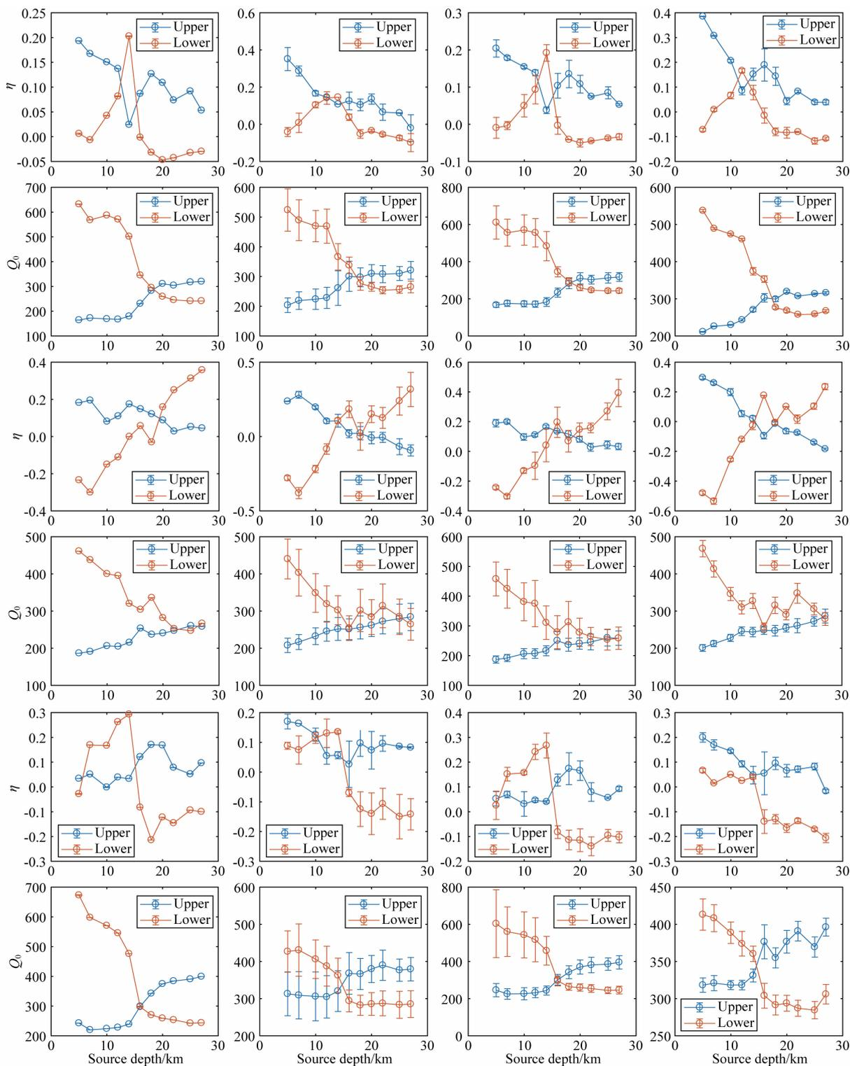
图 8 使用三种模型计算不同震源机制下  $\eta$  值和  $Q_0$  值随震源深度的变化规律
