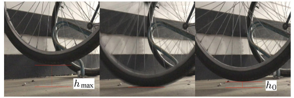
图6 车轮自由下落实验
