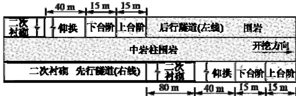
图3 施工工法及工序示意图
