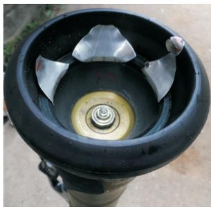
图10 试验后防护圈状态
