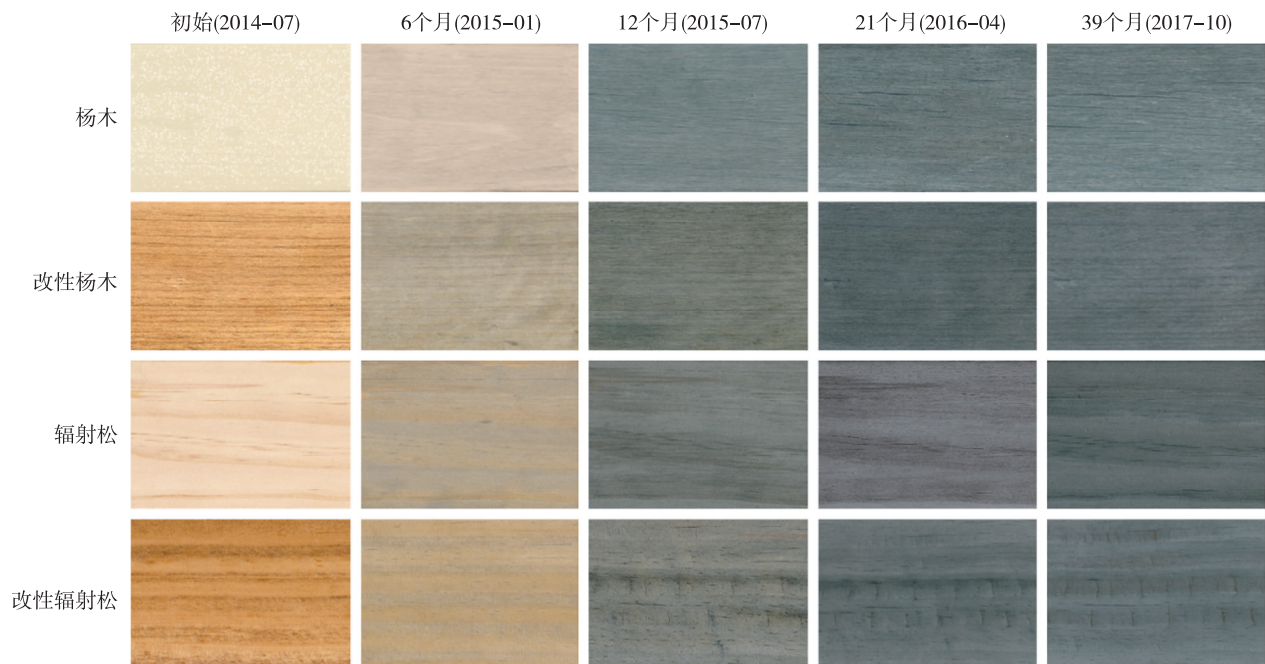
图2 木材在不同老化时间下的表面扫描图
