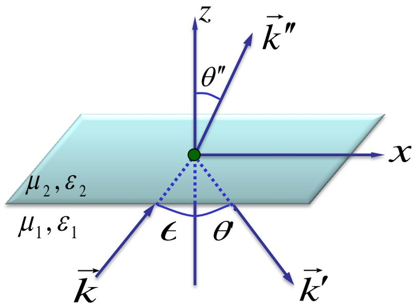
反射波矢、折射波矢与入射波矢在同一平面上(入射面)
