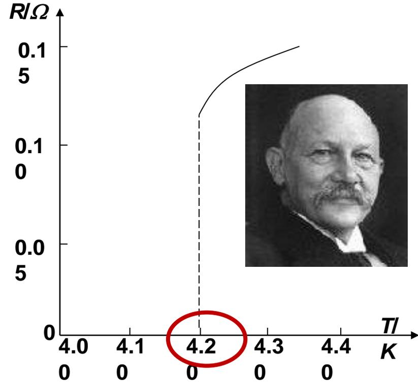
开始出现超导电性的温度称为**临界温度** $T_C$ . 在 $T_C$ 以上, 物体处于正常态, 在 $T_C$ 以下为**超导态**。
