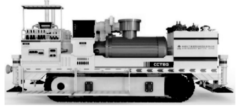
图3 ZDY12000LD 大功率定向钻机
