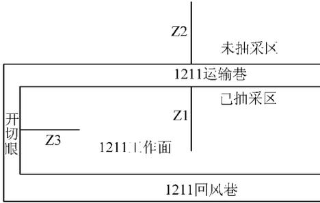
图1 二氧化碳深孔致裂增透孔布置
