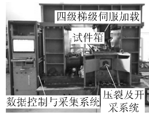
图1 多场耦合煤层气开采物理模拟试验系统
