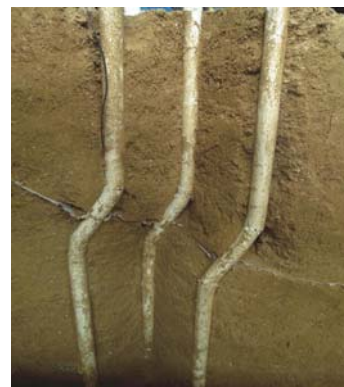
图 13 微型桩破坏情况
