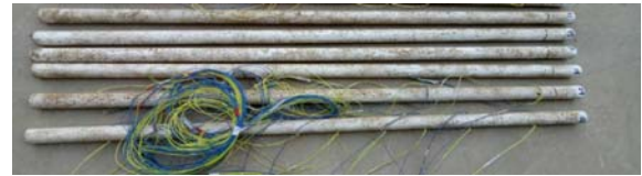
图 1 制作好的微型桩 Fig.1 Test micropiles
