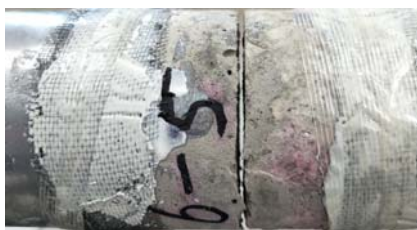
图 11 砂浆 - 花岗岩的动态拉伸破坏 Fig.11 Dynamic tensile damage of mortar-granite
