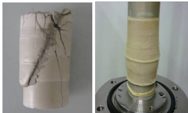
(a) 脆性破坏 (b) 塑性破坏
