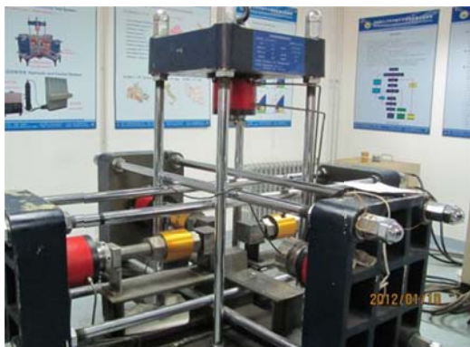
图1 真三轴卸载岩石实验系统 Fig.1 The true triaxial unloading test system
