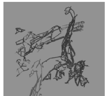
图1 1号样品孔裂隙渗流网络模型
