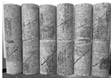
图1 预制裂纹花岗岩试样
