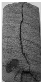
图6 弱胶结砂岩宏观破裂特征
