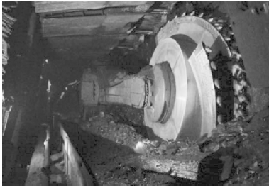
图2 工作面输送机压煤及大块煤堵塞
