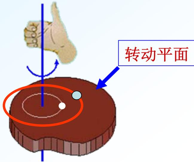
**转动平面：**定轴转动刚体上各质点的运动面
