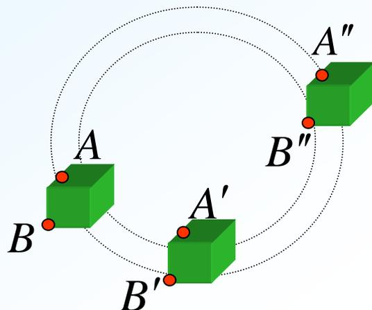
2. 转动(rotation) 刚体上所有质点都绕同一直线作圆周运动。这种运动称为刚体的转动。这条直线称为转轴(rotation axis)。
