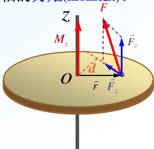
$$\vec{M} = \vec{r} \times \vec{F}_\perp \quad \text{单位: } \text{N}\cdot\text{m}$$
