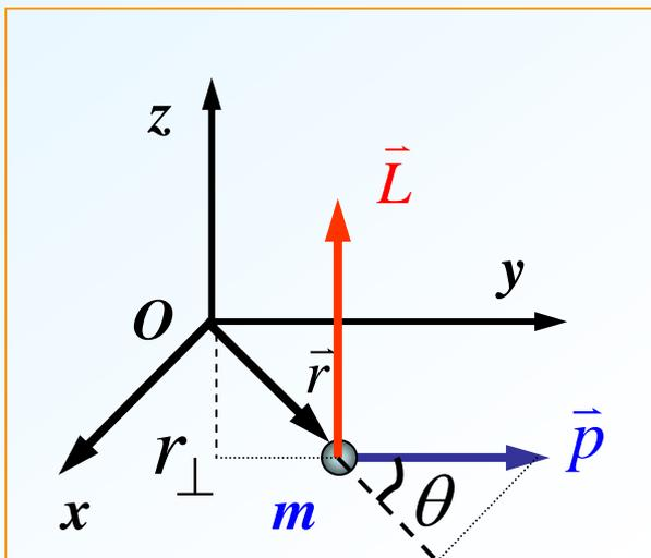
$$\vec{L} \Rightarrow \begin{cases} \text{大小: } L = rmv \sin \theta = r_{\perp} p \\ \text{方向: } \text{垂直于 } \vec{r} \text{ 和 } \vec{p} \text{ 组成的平面} \\ \quad \text{服从右手螺旋法则。} \\ \text{单位: } \text{kg} \cdot \text{m}^2 \cdot \text{s}^{-1} \end{cases}$$
