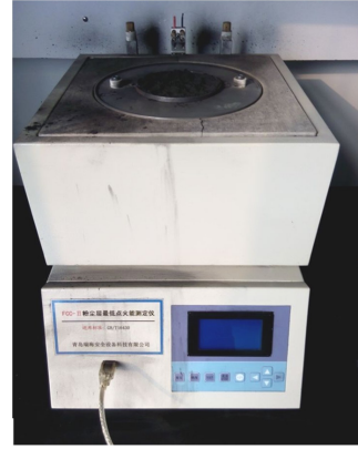
图1 煤尘层最低着火温度测定装置 Fig.1 Coal dust layer MIT tester
