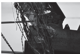
图6 试件RWUF-1.0荷载-位移曲线及破坏现象
