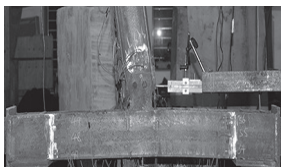
(b) 试件RWUF-1.4边柱Z1弯曲
