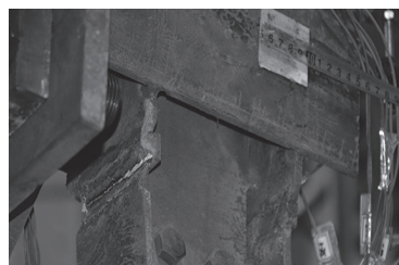
(b) J2处受拉上翼缘断裂
