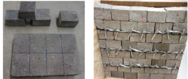
(a) 挡墙面板 (b) 筋材与面板连接方式
