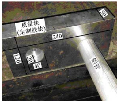
图 3 模型试验中质量块和铝管的尺寸以及拼装方法 (单位: mm)
