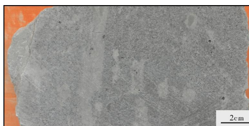
(b) 台内滩滩核。砂屑白云岩,密集发育针孔和小洞。MX12井4635m
