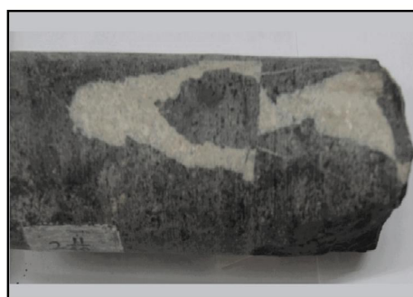
(d) 高角度裂缝被方解石全充填。顺南1井6532.16~6532.34m。岩心。
