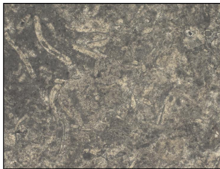
(b) 泥晶生物碎屑灰岩。顺南7井6386m。薄片(-), × 5
