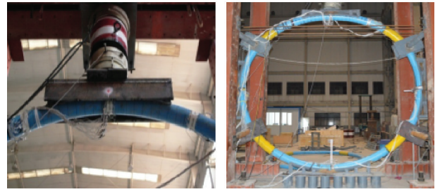
(a) 位移计布置 (b) 监测装置整体效果
