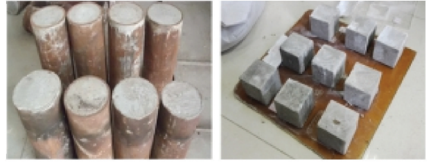
图14 相同水灰比配制的CFST短柱(左)和混凝土(右)单轴抗压强度测试
