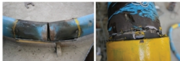
(b) 端头和连接部分破坏
