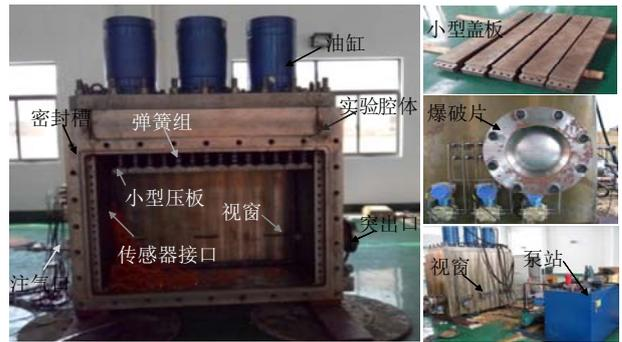
图4 煤与瓦斯突出模型系统实物
