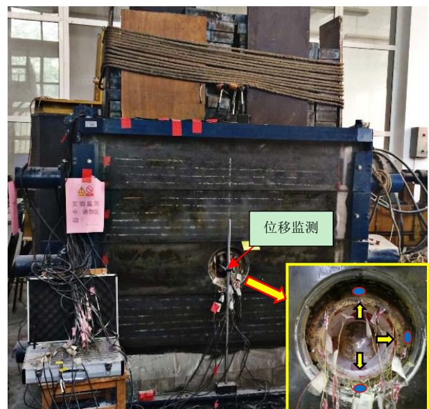
图 13 盾构斜井流变模型试验
