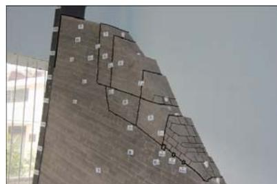
(e) 最终模型破坏形态
