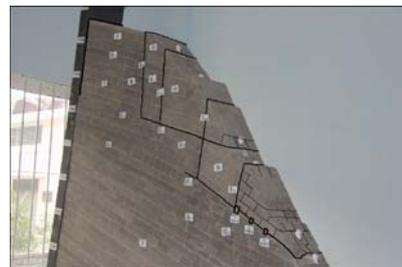
(d) 试验步 30~37( $K_c = 1.406 \sim 1.575$ )模型破坏形态
