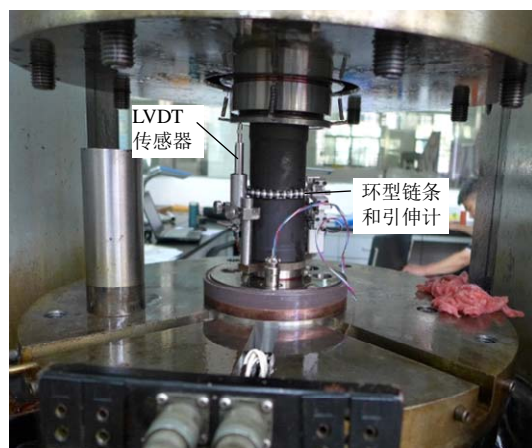
(a) 3DP石膏试样的单轴压缩试验
