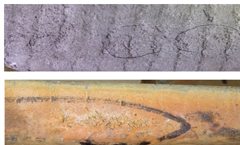
图 3 ER70S 连铸坯酸洗后低倍形貌
