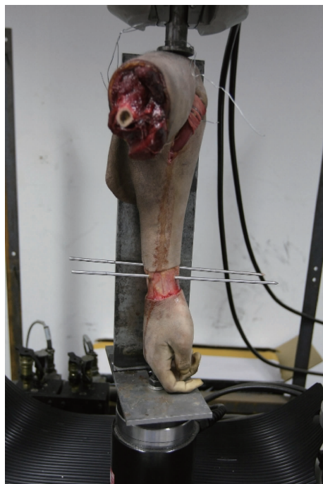
图2 用自制的力学夹具将标本固定于MTS 858 Mini Bionix® II型生物力学仪上,使肘关节屈曲90°,固定尺骨,使桡骨可围绕尺骨自由旋转
