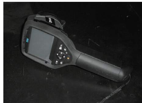
图 3 红外热像仪实物图
