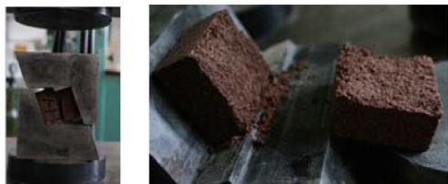
图 2 变角剪切实验
