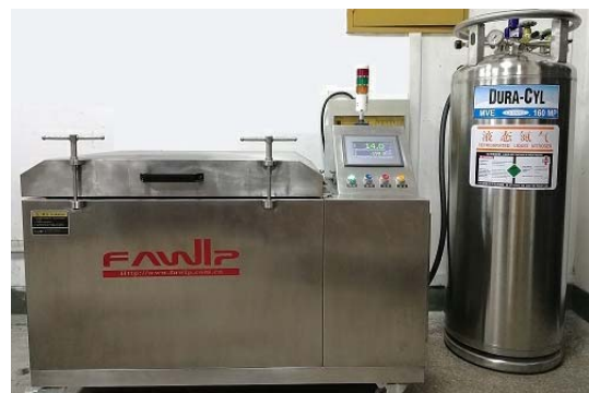
图 2 SLX - 80 型高低温实验系统
