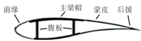
图2 空心薄壁复合结构叶片截面
