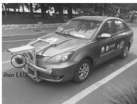
图2 装备 ibeo LUX 的实验车辆
