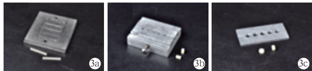
3a: 挠曲强度的模具及试件;3b: 压缩强度的模具及试件;3c: 径向拉伸强度的模具及试件
