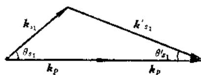
图 6-17 产生一级反斯托克斯散射光的相位匹配
