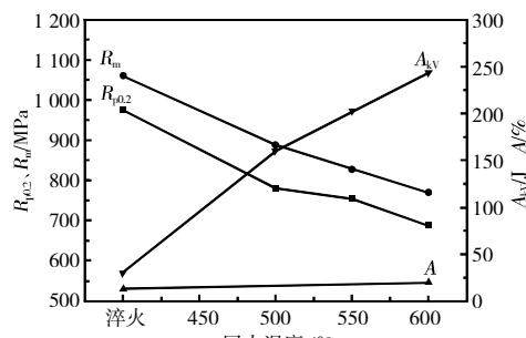
图 1 实验室调质处理后钢板性能
