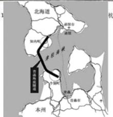
**青函隧道**为双线隧道，1964年开始启动，历经24年的施工建设，世界上最长的机动车隧道。
