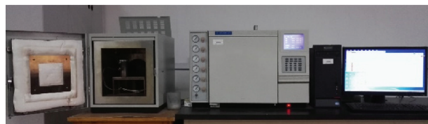
图 1 程序升温氧化动力学测定系统
