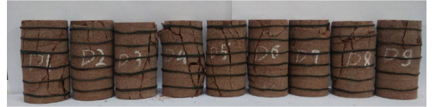
图 6 岩样破坏形态
