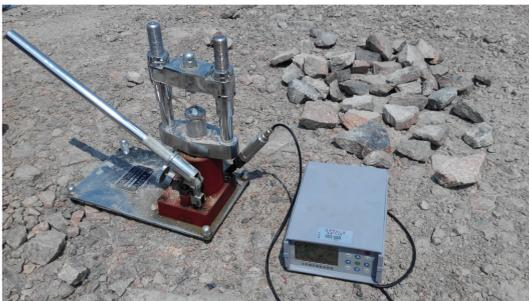
图7 点荷载试验仪器
