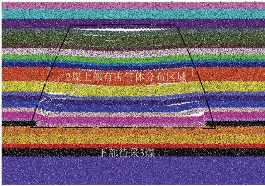
图3 上层煤开挖后垮落压实状态
