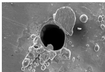
图2 常规打孔时的出口形貌
