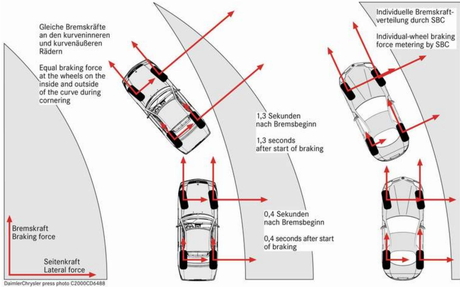
**SBC根据车轮负荷 $F_z$ 确定制动力**
